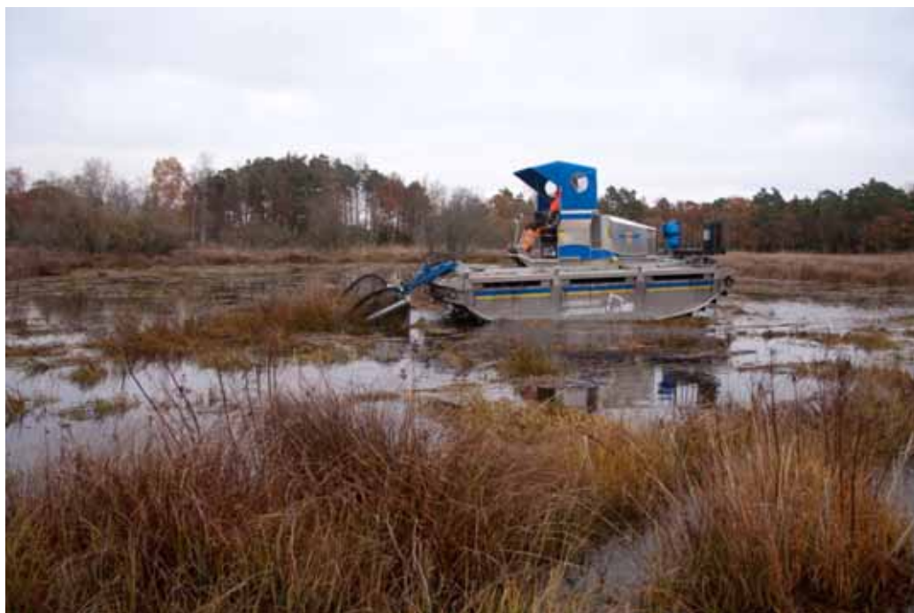
Figur 11. Vegetationsrensning av öppna ytor och vattendrag bör med fördel ske med en för ändamålet anpassad maskin. Här en amfibiegående Truxor som gör minimala körskador. Foto: Micael Söderman.
