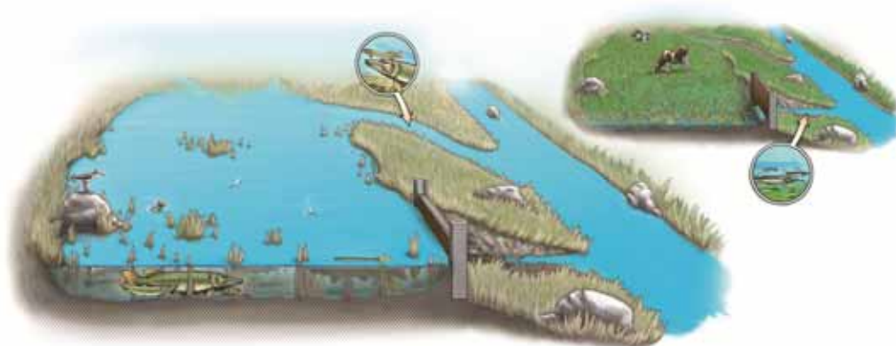
Figur 2. Bilden visar principen hur en översvämning våtmark ser ut och fungerar. Illustration: Erik Ohlsson
