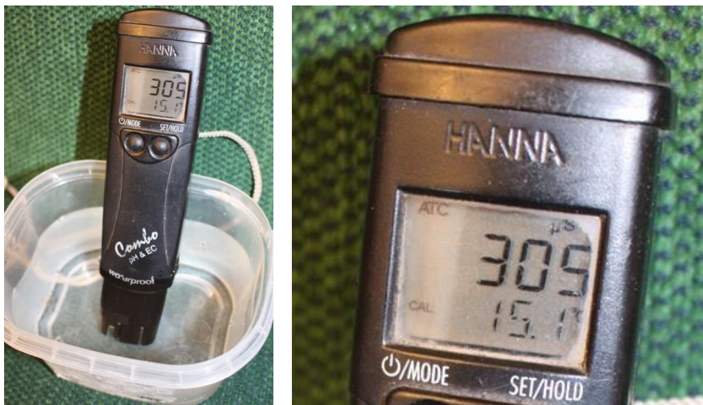
Figur 5. Instrumentet för mätning av konduktivitet, mätt i dricksvatten. Foto: Carl-Johan Månsson
